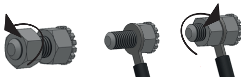
Abb. 3 Der Anschluss des Gerätes an die Einrichtung zum Potentialausgleich
