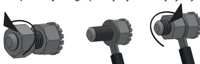
Rys. 2. Podłączenie urządzenia do instalacji wyrównującej potencjały elektryczne.
