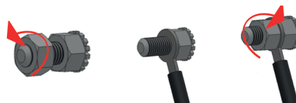
Abb. 4 Anschluss des Geräts an das elektrische Potentialausgleichssystem.
