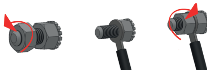
Rys. 4. Podłączenie urządzenia do instalacji wyrównującej potencjały elektryczne.
