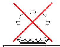
Fond trop petit pour ce brûleur
