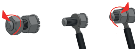
Bild 6. Der Anschluss des Gerätes an die Einrichtung zum Potentialausgleich
