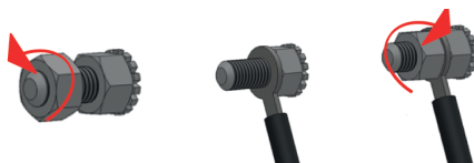
Rys. 4. Podłączenie urządzenia do instalacji wyrównującej potencjały elektryczne.
