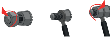
Rys. 4. Podłączenie urządzenia do instalacji wyrównującej potencjały elektryczne.
