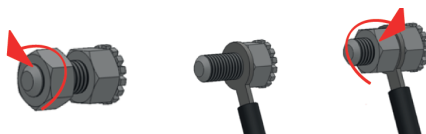
Rys. 4. Podłączenie urządzenia do instalacji wyrównującej potencjały elektryczne.
